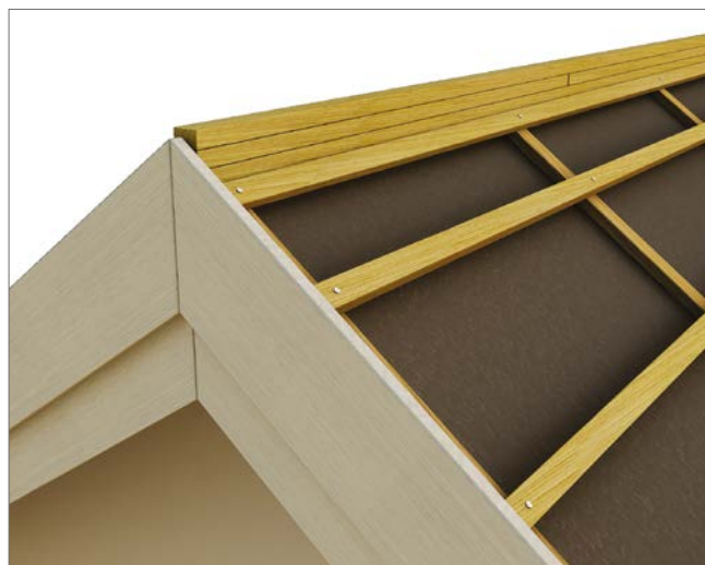
ALTERNATIV 1: Mønelekt – Montering med lektunderbygning, hvis det skal brukes møne-/valmtetningsrull.
